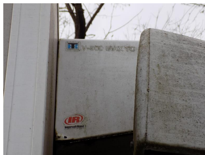
4. Iveco Eurocargo – vrsta rashladnog uređaja
