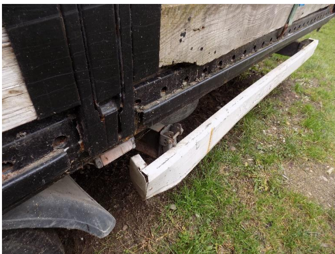
3. Prikolica Krone – oštećenje na prikolici
