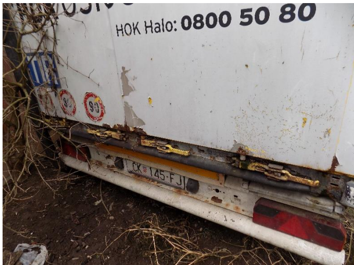
1. Prikolica Krone – oštećenje karoserije
