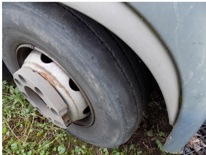
2. Iveco Eurocargo – oštećenost guma
